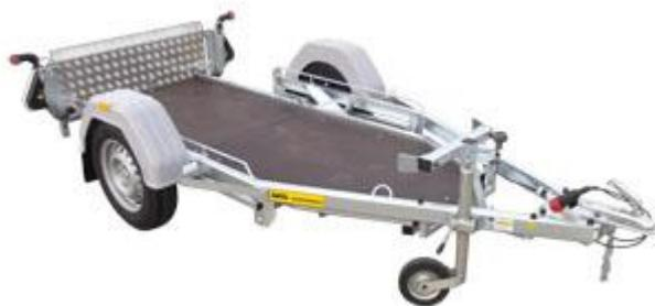
Conçu pour le transport de scooter MP3 et de certaines machines auto-laveuses. Chargement simple, rapide et en sécurité.
